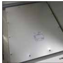
A4. Entfernen Sie die untere Endkappen durch Lösen der vorhandenen Schrauben
