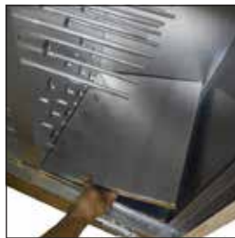
A3. Entfernen Sie die Aluminium-Abschlussplatten
