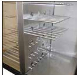
A2. Déplacer à gauche 3 rangées de tiges ou les dévisser (selon le modèle)
